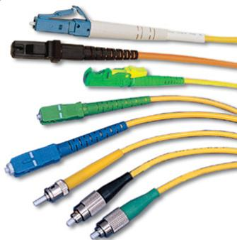
Соединительные (patch-cord) и монтажные (pigtail) оптические шнуры. Все соединительные и монтажные одномодовые (SM) шнуры, стандартно изготавливаются с применением оптического волокна SMF-28 (G.652) (по заказу G.655, G.657 и т.д.). В многомодовых шнурах применяется волокно 50/125 или 62.5/125. Виды шлифовки: PC (physical contact) физический контакт >20дБ
